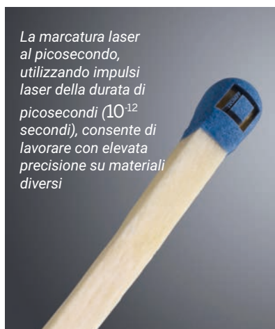
Per l'orologio commemorativo JUNGHANS è stato possibile realizzare una marcatura con una profondità di soli 17 micrometri sufficiente per ottenere un aspetto elegante, senza rimuovere una quantità eccessiva o danneggiare il calore il platino
