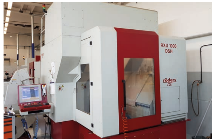
La RXU 1000 è destinata principalmente alla lavorazione dei pezzi di maggiori dimensioni
