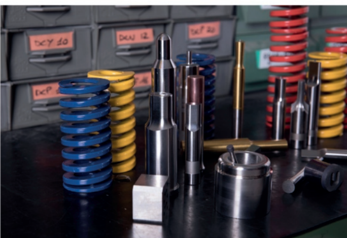
(da sinistra) Alcuni degli elementi tecnici per il raffreddamento e il condizionamento dello stampo plastica e alcuni punzoni con testa cilindrica per stampi lamiera che Rigon è in grado di fornire agli operatori del settore.
