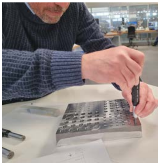
Test cliente / Fase 2: Sono stati verificati i parametri strategici (usura utensile, metri di contatto, assorbimento al mandrino, ecc.) per valutare oggettivamente l'andamento del test
