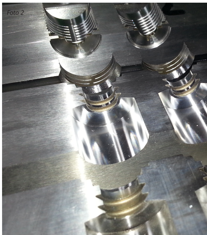
Foto 2 Esempio lavorazione stampo per bottiglia
