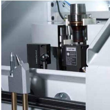
Laser di misurazione nel cambio utensili
