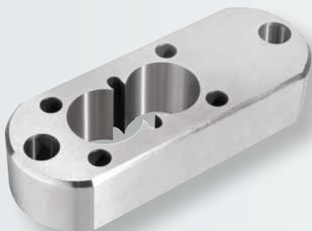
Stampo in metallo duro Fresatura del piano superiore, foratura con punta, rettifica delle pareti
