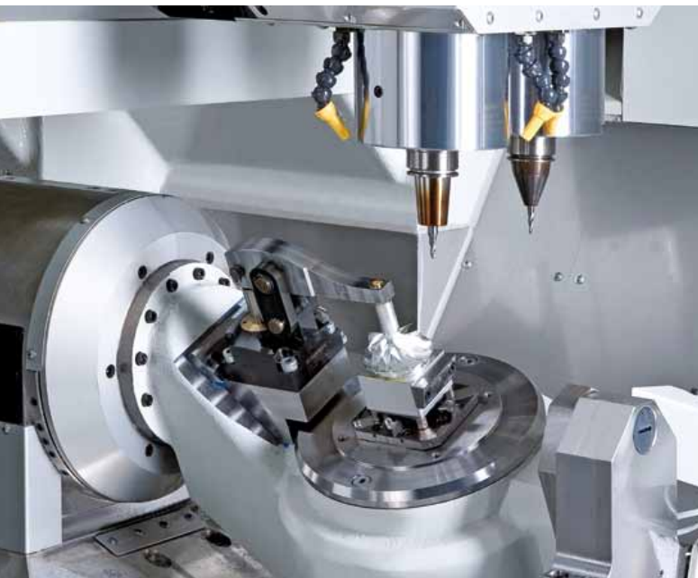
Vano interno della RXS500DSI2, preparato per la lavorazione di giranti
