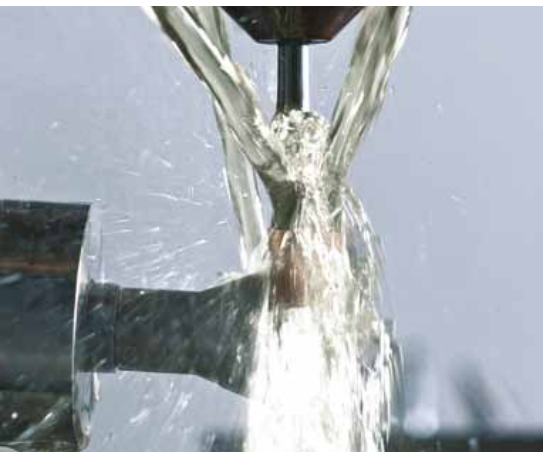
Mandrino di ravvivatura per la riaffilatura della mola di rettifica
