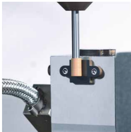
Misurazione dell'emissione acustica della mola di rettifica
